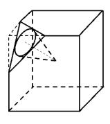
aristas concurrentes en un vértice, por la sección transversal se realiza una perforación cónica tal que la circunferencia base queda inscrita en los lados de la sección transversal y la profundidad del hueco llega hasta el centro del cubo como se
