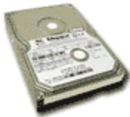
*Discos Duros (HD, Hard Disk):* A diferencia de los discos flexibles, los discos duros están generalmente instalados en el interior del chasis de la Unidad Central de Procesamiento y su velocidad de trabajo en la rapidez de acceso y transferencia de datos es mayor que con los disquetes. Actualmente existen HD externos de diversas capacidades.
