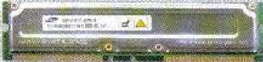
**Rambus:** puede ofrecer velocidades entre 600 y 1.066 MHz. Tiene 184 contactos. Algunos de estos módulos disponen de una cubierta de aluminio (dispersor de calor) que protege los chips de memoria de un posible sobrecalentamiento. Debido a su alto coste, su utilización no se ha extendido mucho.
